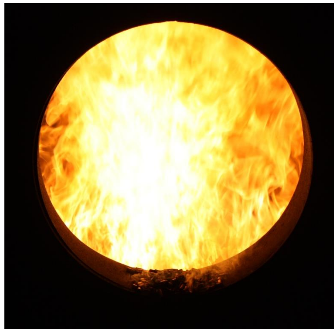
Рисунок 5 – Горение соломенных пеллет в топке котла
